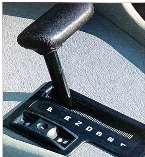
Sonderausstattung: die 4-Gang-Automatic mit elektronisch-hydraulischer (EH)-Steuerung für 3 Fahrprogramme.
