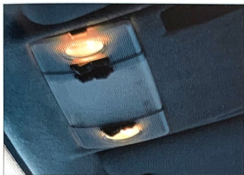
③⑥ Leseleuchten vorn. Durch gezieltes Ausrichten eine angenehme Erleichterung, z. B. beim Kartenlesen bei Nachtfahrten. Getrennte Leuchten und Schalter für Fahrer und Beifahrer. (Ab 735i Serie.)
