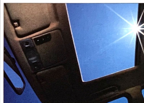
④① Elektrisches Stahlkurbelhebebedach mit integriertem Windabweiser. Betätigung über Schalter am Dachhimmel vorn mit Tippautomatik und Schließmöglichkeit über das Fahrertürschloß.
