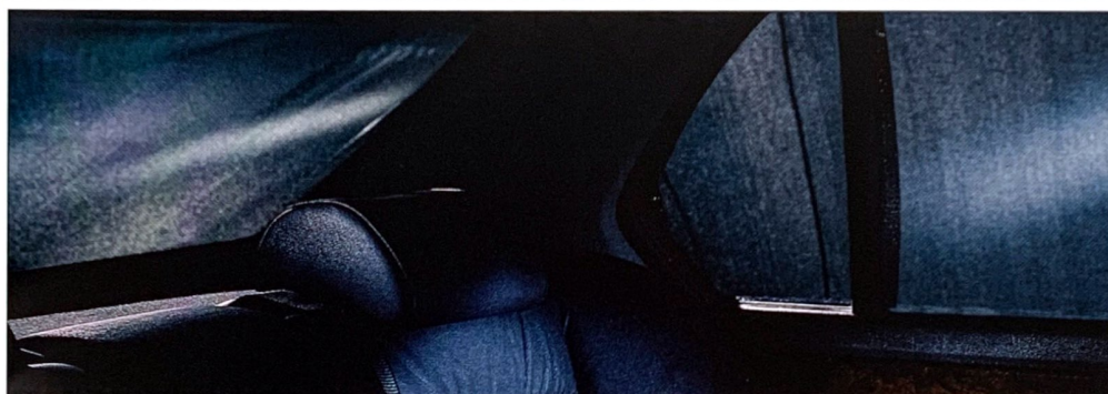
③⑦ Elektrisches Sonnenschutzrollo für die Heckscheibe und mechanische Rollos für die hinteren Türscheiben. Sie reduzieren die Sonneneinstrahlung auf den Fondsitzen und die Aufheizung des Innenraums.
