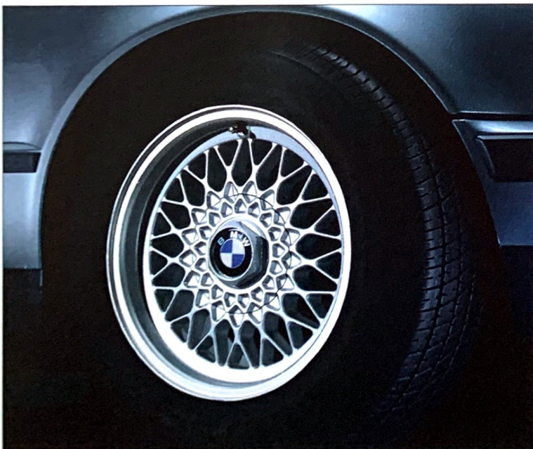
⑤ BMW Leichtmetallräder 7 J x 15 im Kreuzspeichen-Styling mit 225/60 ZR 15 Niederquerschnitt-Reifen, inkl. Radschraubensicherung.
