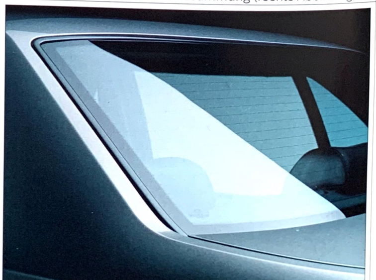
⑤① Verbundglasheckscheibe. Zusätzliche Sicherheit, z. B. bei Steinschlag, und erhöhter Geräuschkomfort.
