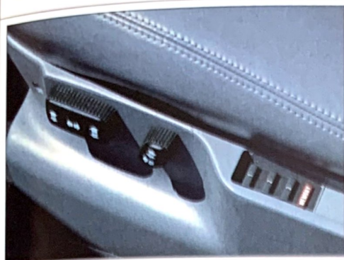
②③ Elektrische Sitzverstellung mit Memory für den Fahrersitz. Die Idealsitz- und Außenspiegelpositionen von drei Personen können gespeichert und bei Bedarf abgerufen werden.
