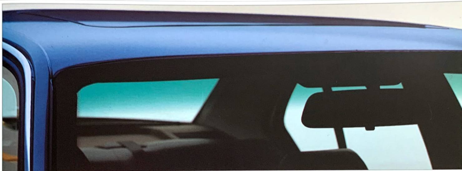
① Grünkeil in der Frontscheibe bei serienmäßiger Wärmeschutzverglasung. Ein zusätzlicher Schutz gegen Sonnenblendung und Strahlungswärme.
