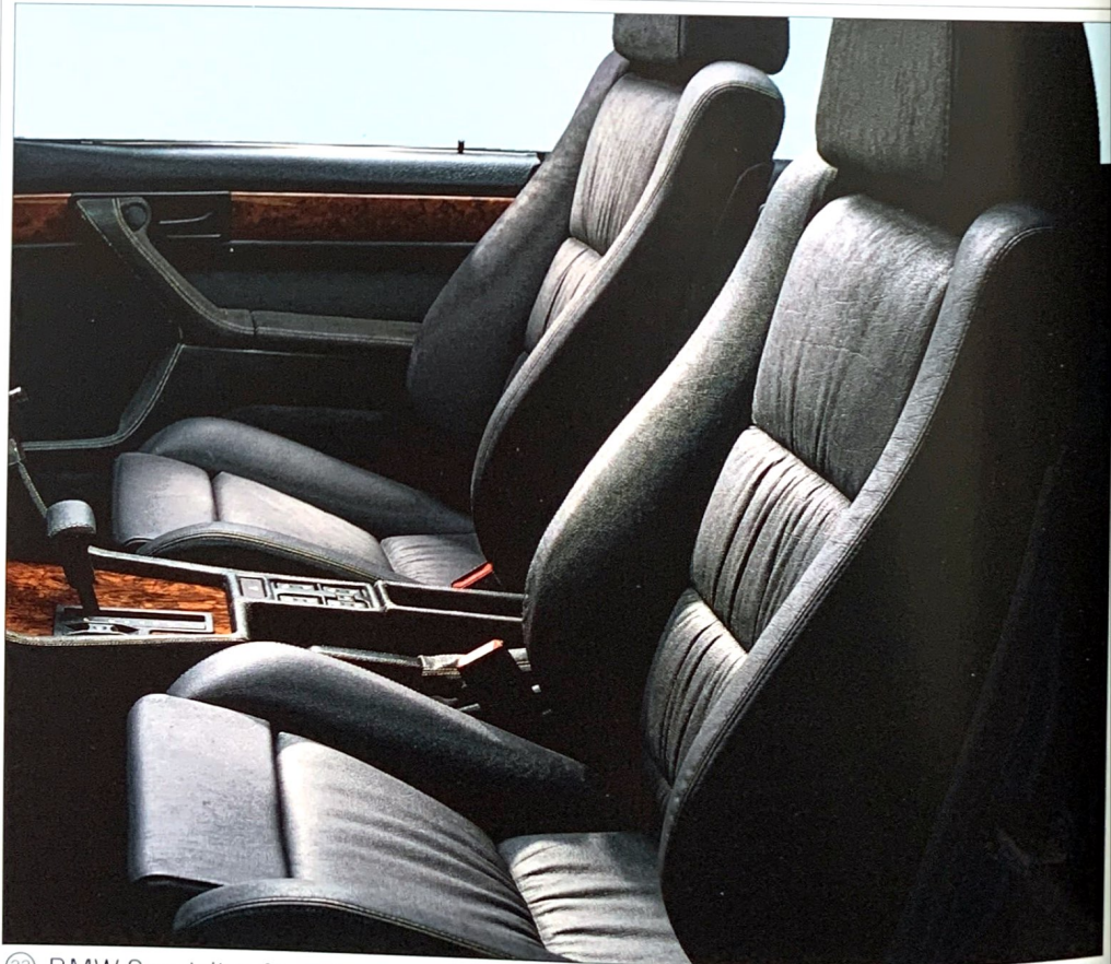
㉒ BMW Sportsitze für Fahrer und Beifahrer, alle Funktionen elektrisch. Zusätzlich mit Verstellmöglichkeit der Oberschenkelauflage. (Nicht für 735iL.) Die optimale
