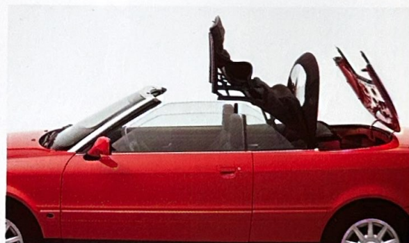
Der Verdeckkasten wird geöffnet und das faltverdeck nach hinten geklappt.
