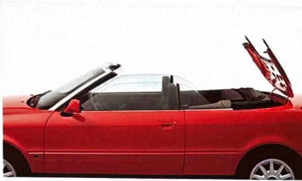
Das faltverdeck lässt sich komplett im Verdeckkasten versenken.
