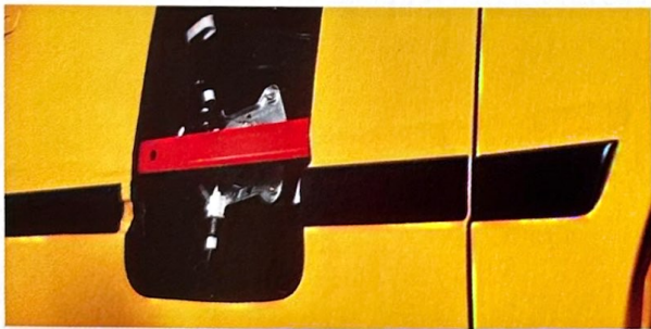
Durch hochfeste Strangpreßprofile in den Türen kann sich in bestimmten Unfallsituationen die Türsteifigkeit verdoppeln.
