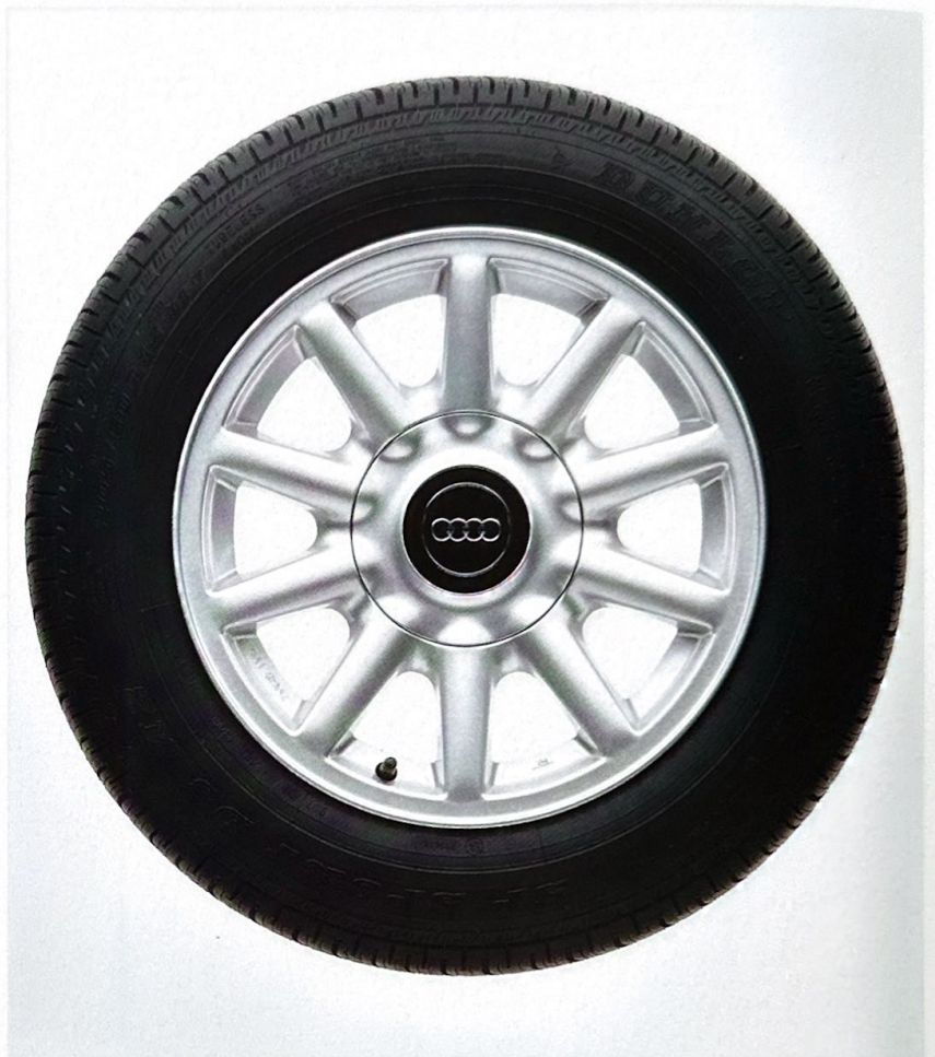
Audi Leichtmetallrad im 10-Speichen-Design 7 J x 15 mit Reifen 195/65 R 15 V, 205/60 R 15 V, 215/60 ZR 15 und 8 J x 17 mit Reifen 245/40 ZR 17.
