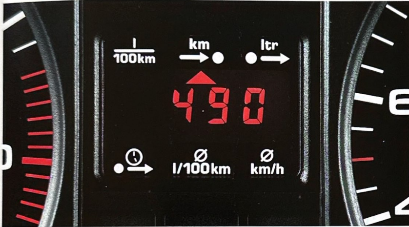
Bordcomputer. Mit digitaler Anzeige zur sekundenschnellen Überprüfung folgender Funktionen: Momentanverbrauch (bei Audi Coupé S2 und Audi S4/Avant statt dessen Ladedruck), Reichweite, verbrauchte Kraftstoffmenge, Fahrzeit (max. Anzeige 23 Stunden, 59 Minuten), durchschnittlicher Kraftstoffverbrauch und durchschnittliche Fahrgeschwindigkeit.
